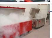
Bei der Tieftemperaturbehandlung werden die Blechblasinstrumente und Saiten sehr langsam auf Temperaturen von -180°C abgekühlt und nach ca. 15 Std. wieder auf Raumtemperatur erwärmt. Der dabei erzielte Spannungsabbau im Gefüge reduziert die Störstellen im Material.
